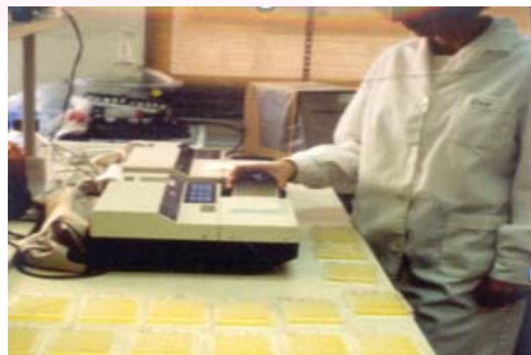
Figura 6. El uso de lectores automáticos permitió realizar cinéticas de la reacción y aplicar la técnica ELISA a miles de muestras de una forma objetiva (cuantitativa). En la imagen, el primer lector adquirido en el IVIA en 1978.
