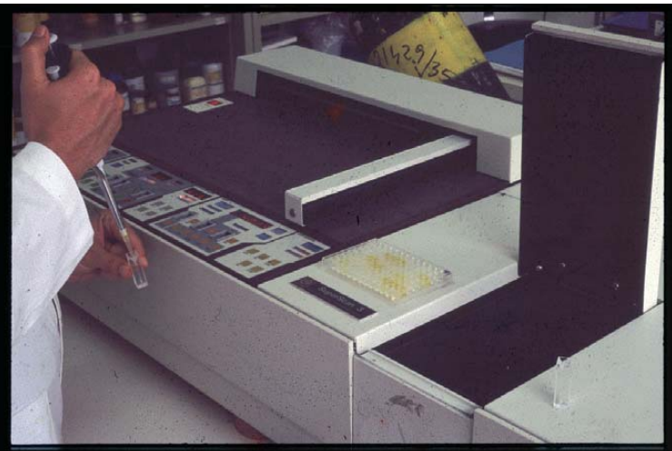
Figura 5. Inicialmente, se efectuaba la lectura de placas ELISA visualmente, una vez frenada o paralizada la reacción por adición de 50 microlitros/pocillo de NaOH 10M. También se leían trasvasando el contenido de cada pocillo a una microcubeta para determinar la absorbancia o densidad óptica en un espectrofotómetro a 405 nm para el color amarillo de la fosfatasa alcalina, y obtener así valores ELISA cuantitativos.
