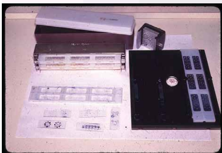
Figura 1. Equipo de inmunodifusión: mesa de nivel para el medio con agar en soportes de plástico para portaobjetos de cristal, tanques incubadores y troquel. En la parte inferior izquierda de la vetusta diapositiva, varios ejemplos ya desecados y teñidos de comparación de antígenos por inmunodifusión doble o de Ouchterlony (el antisuero diluido en el pocito central; y, alrededor, distintos antígenos para ser comparados) y titulación de antisueros en diluciones seriadas de los mismos.
