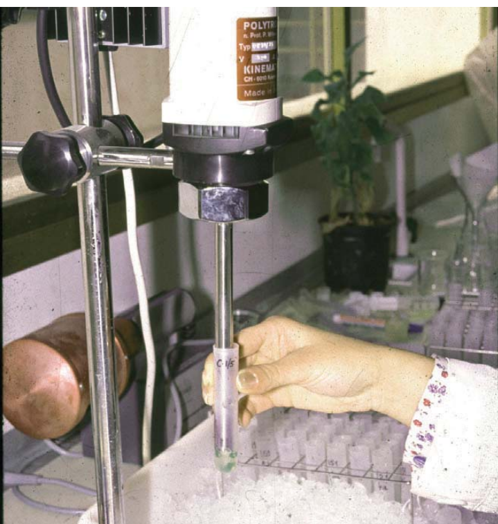
Figura 7. La preparación de muestras de plantas leñosas en homogeneizadores de vástago tipo Polytron®, permitió analizar más fácilmente extractos y popularizar la detección y diagnóstico en dichos cultivos.
