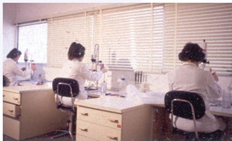
Figura 8. Tres operarios con homogeneizadores de vástago en el laboratorio de ELISA diseñado en 1981 en el servicio de Sanidad Vegetal de Silla (Valencia), para análisis masivo de muestras de especies leñosas. Permitía analizar 900 árboles/día.
