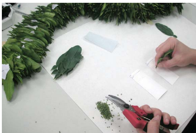
Figura 13. Ristra de hojas de cítricos insertadas en alambre para su análisis por inmunopresión-ELISA en laboratorio. La imagen da idea del número de muestras que es posible analizar por esta técnica de una forma sencilla, sensible y económica.
