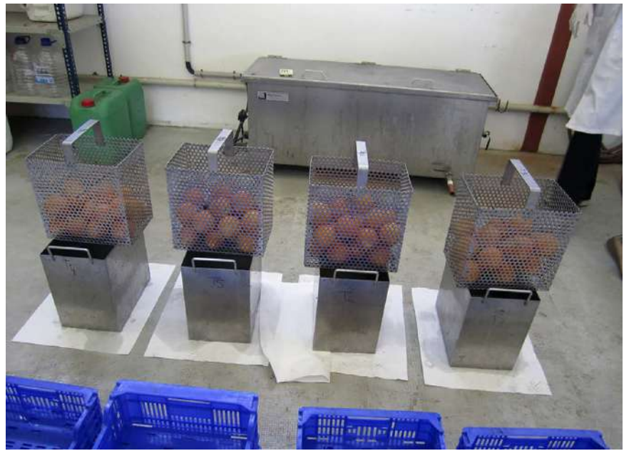
Fotografía 4. Bañadora, cubos y cestos metálicos utilizados para los tratamientos por inmersión de frutos cítricos en soluciones acuosas de aditivos alimentarios.
