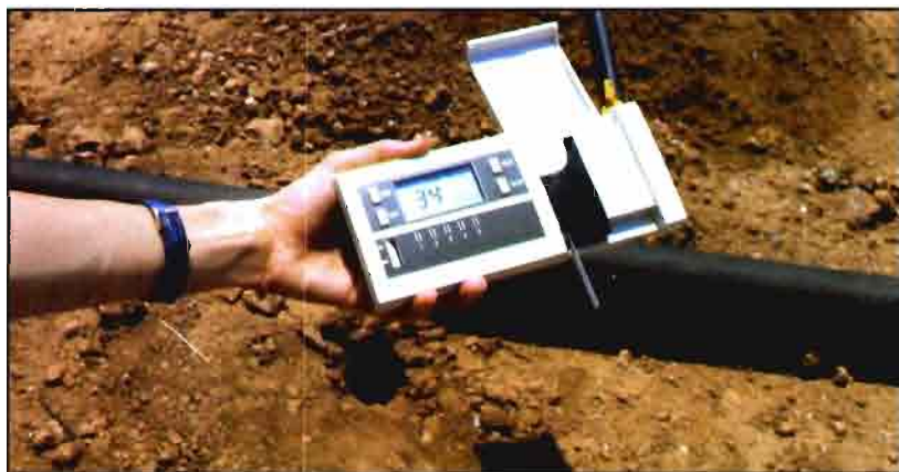
El aporte de nitrato en el agua de riego puede determinarse fácilmente con medidores portátiles.
