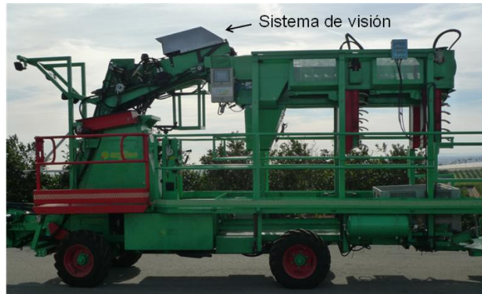
Figura 4. Vista general de la plataforma móvil con el sistema de visión por computador en la parte superior
