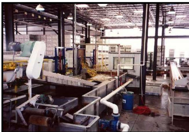
**Fotografia 6.** Tractament comercial de taronges amb una solució calenta de carbonat sòdic en una central cítrica de Califòrnia.
