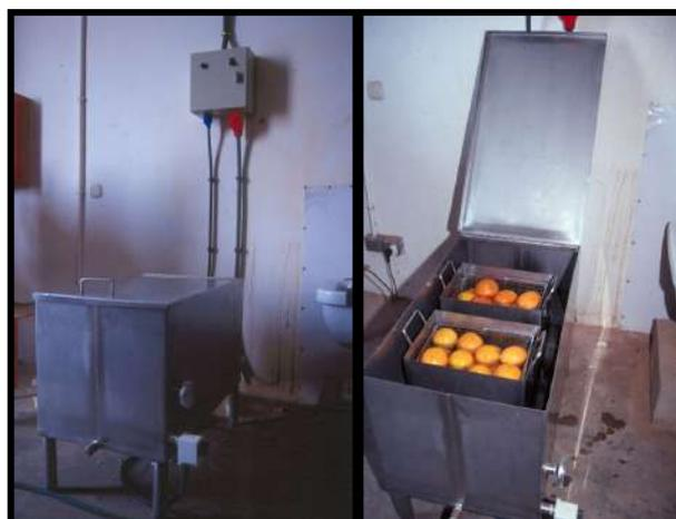
**Fotografia 4.** Banyadora d'acer inoxidable de 172 l de capacitat, amb resistència elèctrica de 9 kW i termostat, utilitzada per als assajos amb aigua calenta i solucions de carbonat o bicarbonat sòdic realitzats al Centre UdL-IRTA de Lleida.
