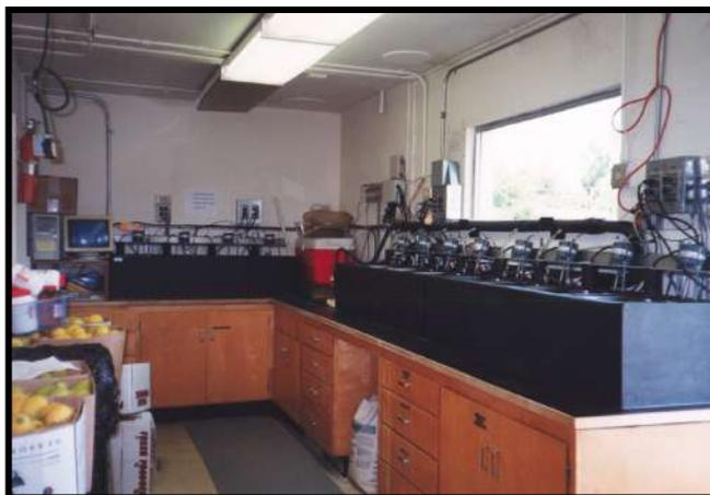
**Fotografia 5.** Sistema de dotze tancs d'acer inoxidable de 22 l de capacitat utilitzat per als assajos amb aigua calenta i solucions de carbonats sòdics o altres additius alimentaris realitzats a l'Horticultural Crops Research Laboratory de Fresno (Califòrnia). Cada tanc està equipat amb un escalfador elèctric controlat per ordinador, un sensor de temperatura i un agitador mecànic accionat amb un motor elèctric.
