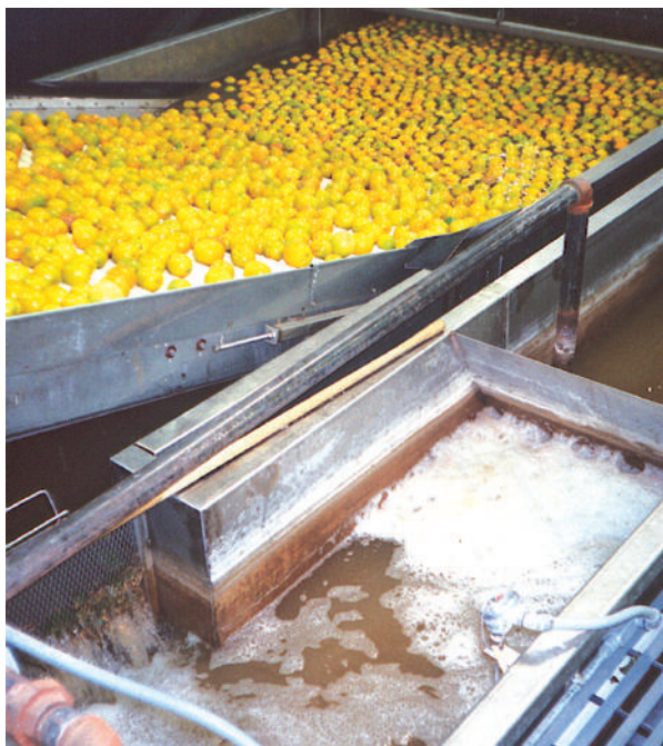
Figura 5. Tratamiento de cítricos por inmersión en una solución caliente de carbonato sódico en una central de California.
