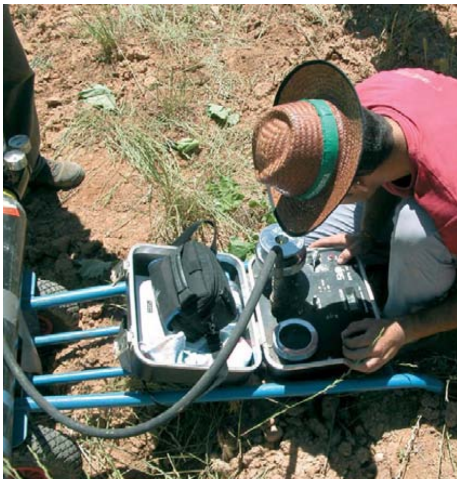
Foto 2. El estado hídrico de las plantas se determinó mediante una cámara de presión.
