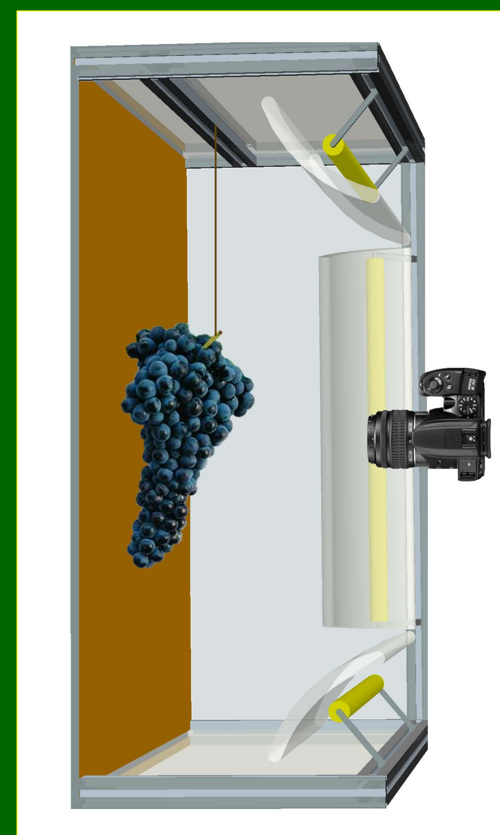
Representación de la configuración utilizada para la toma de imágenes en laboratorio.
