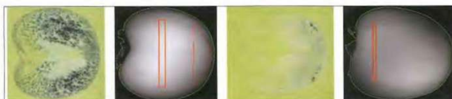
Figura 3. Selección de regiones de interés en la imagen hiperespectral para calibrar el modelo PLS teniendo en cuenta la distribución de taninos obtenida tras la reacción con \text{FeCl}_3 . A la izquierda fruta totalmente astringente (0h) y a la derecha fruta no astringente (24h).
