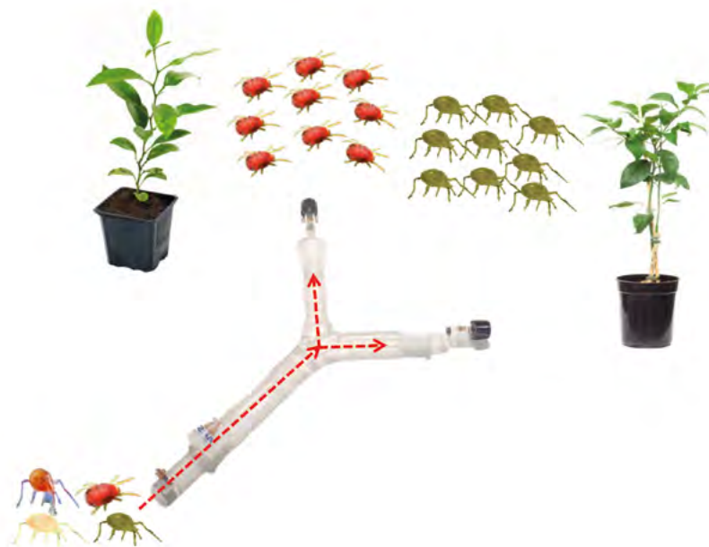
Figura 1. Olfactómetro 'Y'. Cada una de las especies de ácaro estudiadas se liberan en la base de la 'Y', de forma individual para que el ácaro se desplace y elija entre los dos brazos, donde se colocan distintas fuentes de olor: aire limpio frente a T. urticae o E. stipulatus , plantas infestadas o no por T. urticae o E. stipulatus .
